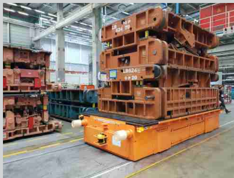
Akumulátorový vozík pro dopravu forem v automatickém provozu.
