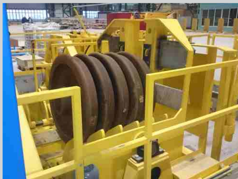
Vozík s polohovacím zařízením na kola podvozků valkových jednotek.
