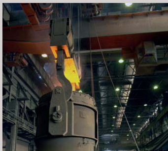
Gießkrane Pouring Cranes
