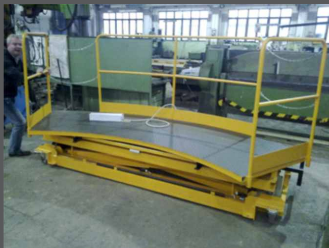
▲ Přesuvna na pneumatikách se speciálním zakrytím.
