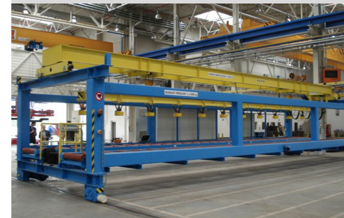
▼ Nadúrovňová plně zakrytá kolejová přesuvna s nosností 80 000 kg a délkou 30 m s nájezdovými klíny pro dopravu železničních jednotek.
