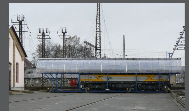
▼ Zapuštěná částečně zastřešená kolejová přesuvna o nosnosti 120 000 kg a délce 21 m pro dopravu železničních jednotek. Poloautomatické ovládání z kabiny.
