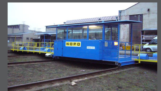
▲ Zapuštěná kolejová přesuvna s nosností 135 000 kg a délkou 24 m pro dopravu železničních jednotek. Poloautomatické ovládání z kabiny.
