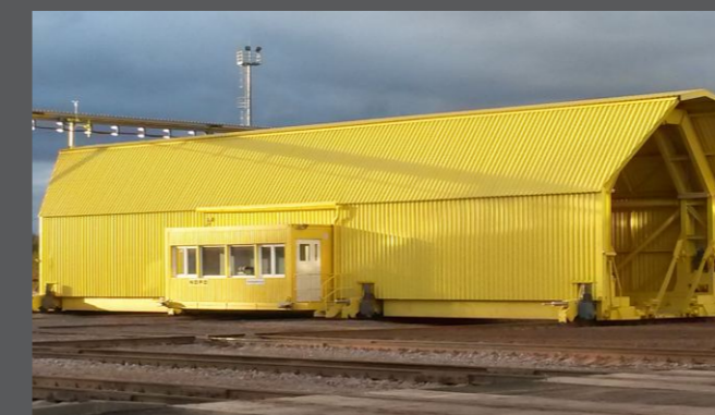
▼ Nadúrovňová plně zakrytá kolejová přesuvna s nosností 80 000 kg a délkou 30 m s nájezdovými klíny pro dopravu železničních jednotek.
