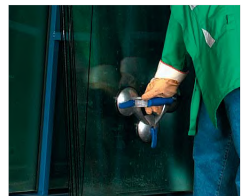
Vakuumheber, z.B. für den Transport von Glasplatten
