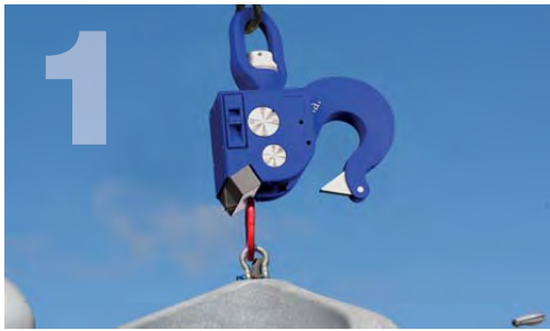
Der integrierte Magnet zieht das Aufhängeglied an...
