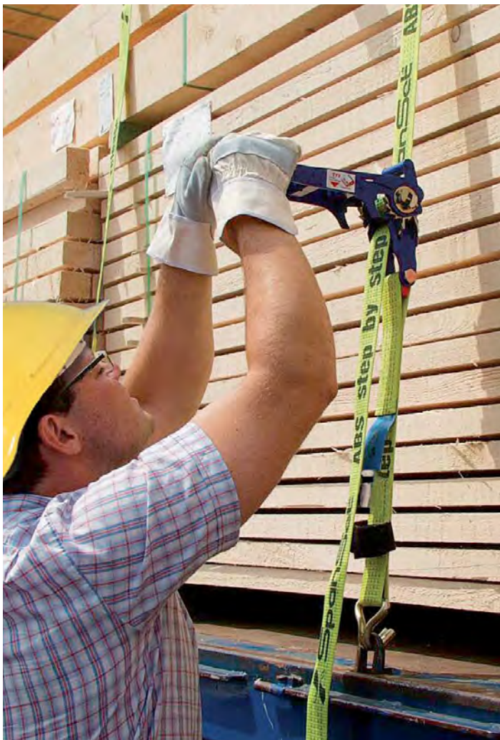
Aufbau einteiliger Zurrgurt
