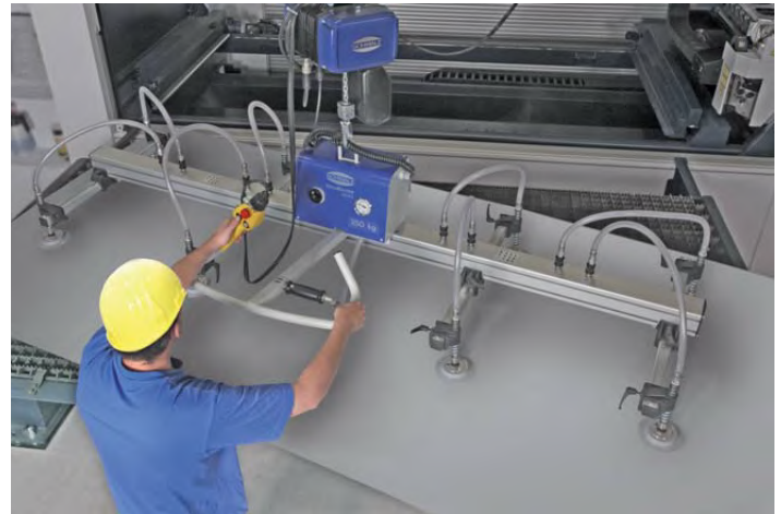
VacuMaster Basic für horizontale Handhabung, 250 kg Traglast
