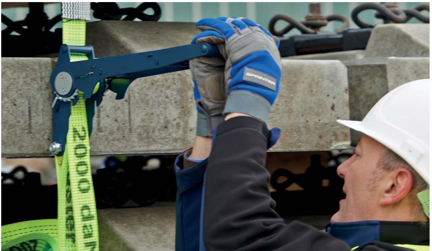
Aufbau einteiliger Zurrgurt
