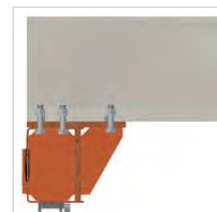
Ausführung B schraubbar für auflegbaren Hauptträger
