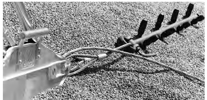
Habegger Mehrzweckzug HIT 32 gesichert mit Titan-Feldverankerung.
