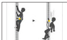
LADDER CLIMB-Steigschutzöse: Befestigung des Läufers des schienen- oder drahtseilgeführten vertikalen Steigschutzsystems.
