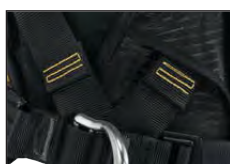
Sturzanzeiger an der sternalen und der dorsalen Auffangöse. Ihre Aktivierung nach einem Sturz signalisiert, dass der Gurt ausgesondert werden muss.
