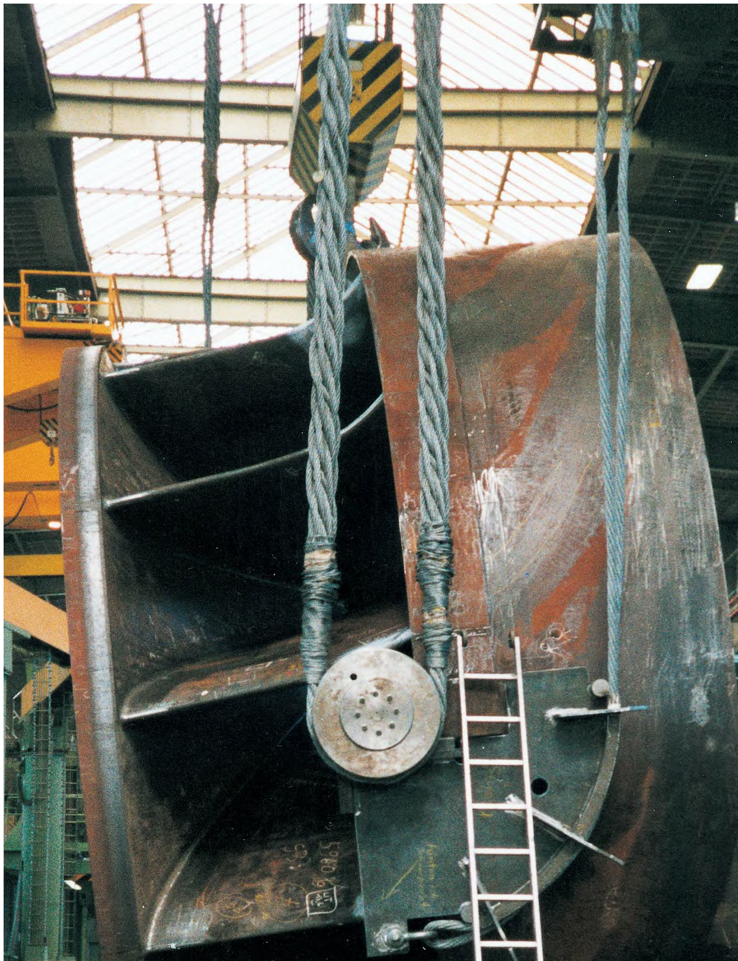
Einsatz einer Kabelschlagseilschlinge mit gespleißten Schlaufen.
