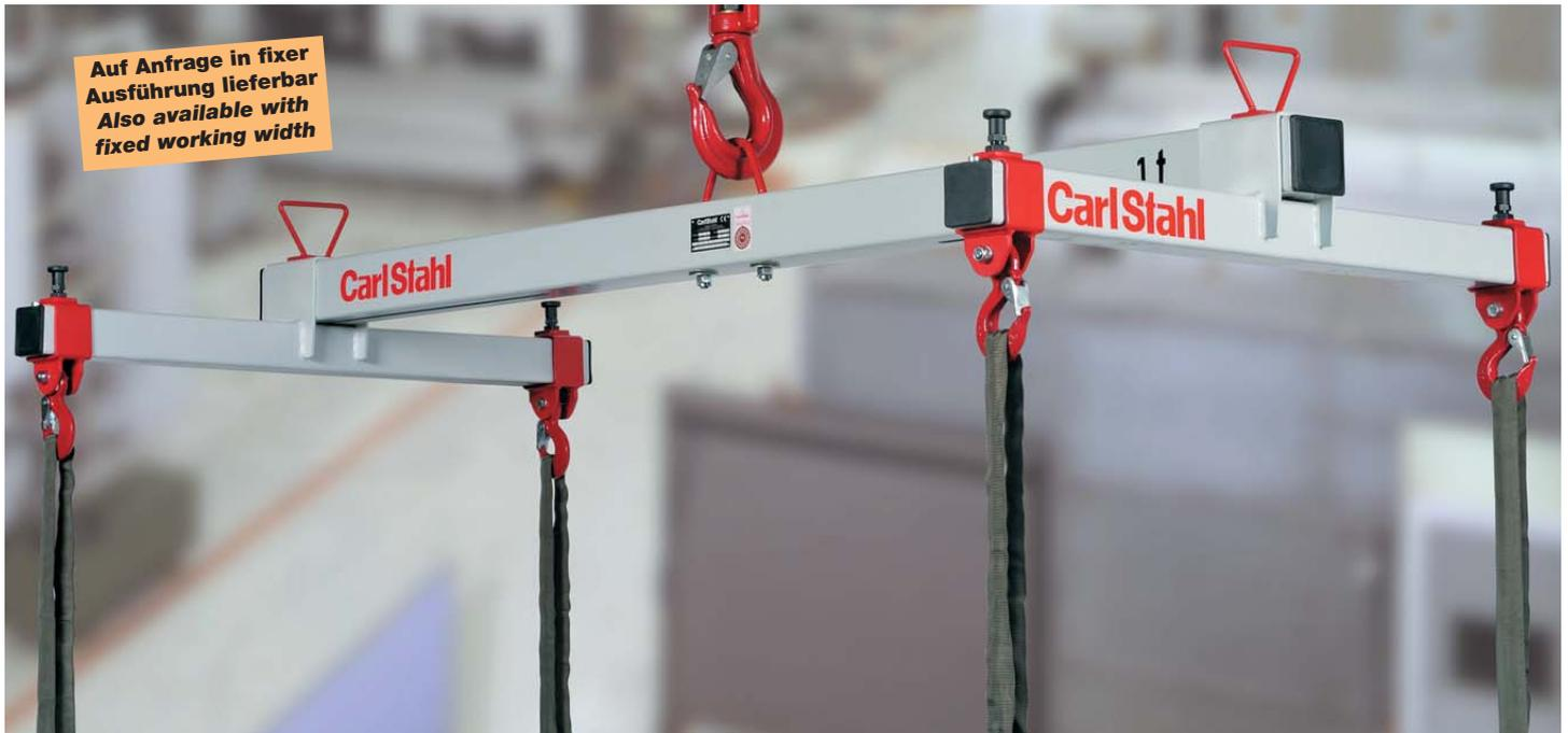
verstellbar mit gebogener Aufhängeöse als Einpunkt-Aufhängung, passend für Kranhaken nach DIN 15401 und mit vier im Raster allseitig verstellbaren Sicherheitslasthaken.
